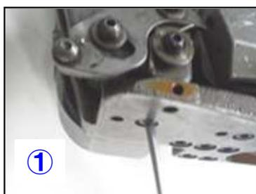
①六角レンチ(3mm)にてボルトを取り外します。
