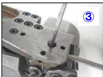
③調整後ポイントとシムを機体にボルトで固定し完了です。
