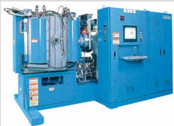
UBMS + AIP処理装置
